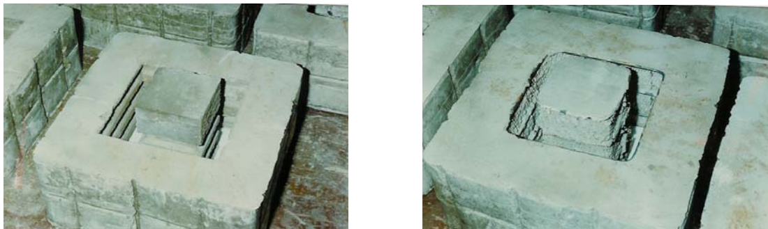
Abbildung 13: Versuchskörper nach Betonage des ersten Betonierabschnitts (links: konventionell; rechts: Stremaform)
